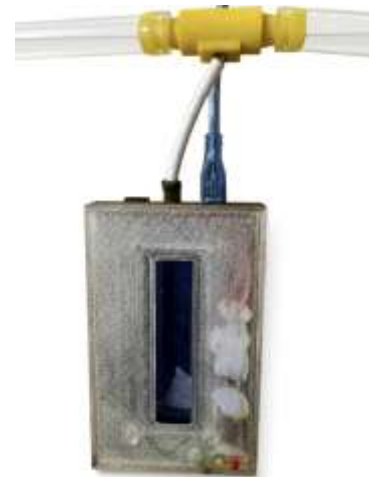
Рис. 2. Мікроконтролерний вимірювальний блок засобу експрес-контролю
