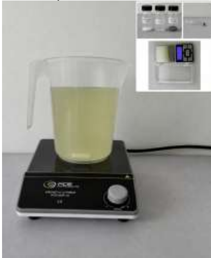
Рис. 3. Приготування модельних проб палива: магнітна мішалка з мірним стаканом, модельні домішки (дибензотіофен, вода, механічні домішки), шприц-дозатор та аналітичні ваги
