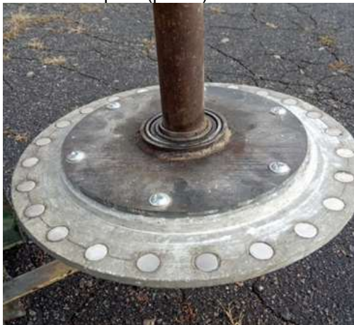
Рис. 3 Загальний вигляд дискового ротора вертикально-осьового вітроелектрогенератора з циліндричними магнітами Nd-Fe-B.
