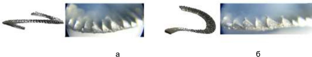
Рис. 9. Стружка при точінні титанового сплаву ВТ22(а), нікелевого сплаву ХН73МБТЮ(б)
