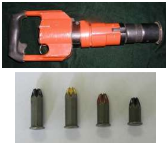
Рис. 1. Монтажний пістолет ПЦ-84 та патрони до нього
