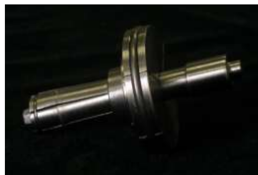
Рис. 4. Технологічна оснастка для розвальцювання труб у трубних решітках у зборі
