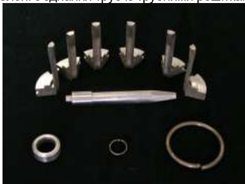
Рис. 3. Технологічна оснастка для розвальцювання подетально та зварювання вибухом труб з трубними решітками
