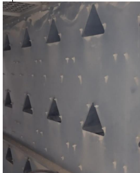
Рис. 3 Зовнішній вигляд секції зерносушарки типу BRICE-BAKER
