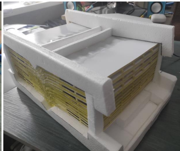
Рис. 3. Схема (а) і загальний вигляд (б) лабораторного стенду для дослідження теплообмінника побічно-випарного типу
