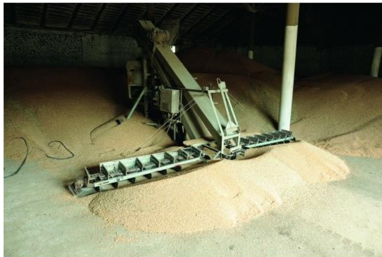
Рис. 1. Зернометач самопересувний ПЗМ-120М
