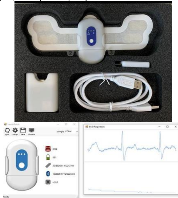
Рис. 1. Фото сенсора TNO Holst Centre 3v1 для вимірювання частоти серцевих скорочень, дихання та активності одночасно
