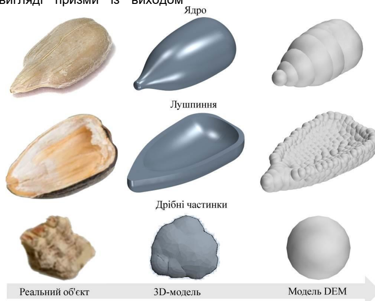
Рис. 1. Апроксимація форми компонентів відходів насінневої суміші соняшнику
