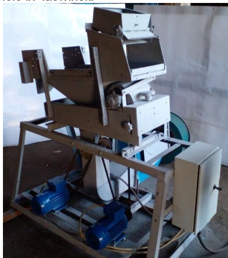
Рис. 6. Загальний вигляд конструкції вібропневмоімпульсного сепаратора
