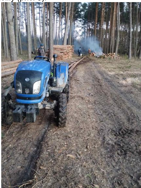
Рис. 5. Трелювання хлистів за допомогою малогабаритного трактора Dongfeng 244 DHX з гідрозахватом PALMS C1
