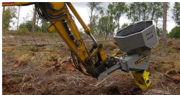
Рис. 6. Створення лісових культур за допомогою змінного навісного обладнання Bracke P11.A
