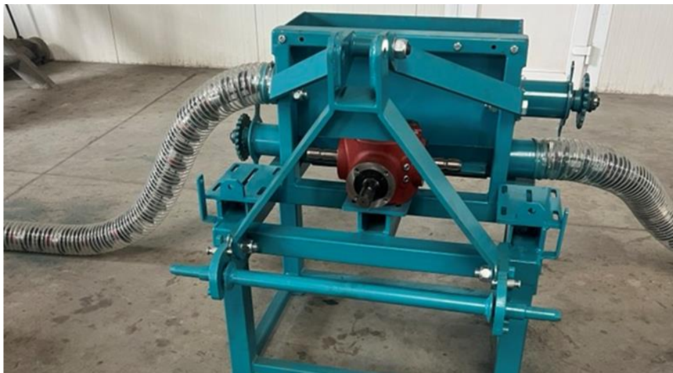
Рис. 6. Конструктивна схема (а) та загальний вигляд (б) гнучкого гвинтового конвеєра: 1 – рама; 2 – завантажувальна магістраль; 3 – вивантажувальна магістраль; 4 – отвір самозавантаження; 5 – отвір вивантаження; 6 – перевантажувальний патрубок; 7 – проміжний вал; 8 – нижній кронштейн; 9 – верхній кронштейн
