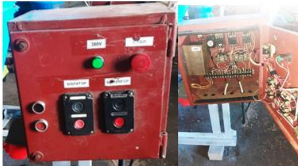
Рис.3. Система керування і регулювання основних приводів установки
