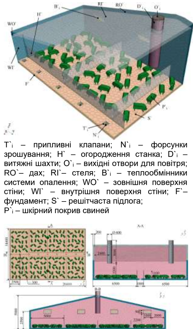
Рис. 1. Сіткова модель приміщення для утримання свиней із підлоговою системою вентиляції
