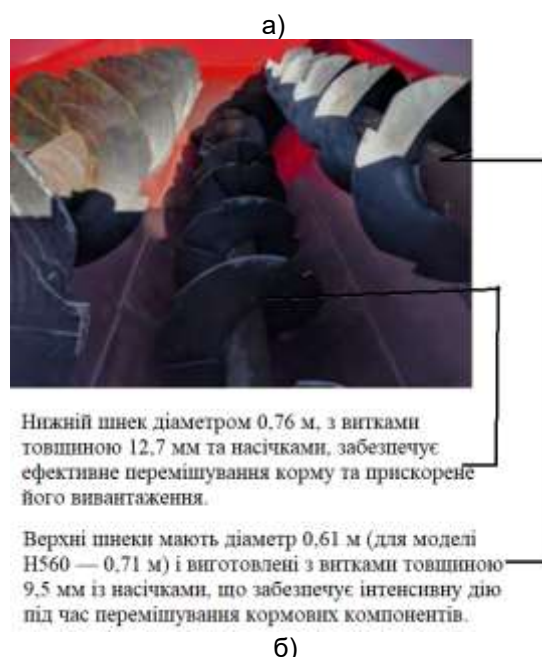
Рис. 10. Робочі органи TMR змішувачів компанії «NDEco»: а) вертикальний шнек із ножами; б) компонування системи горизонтальних шнеків
