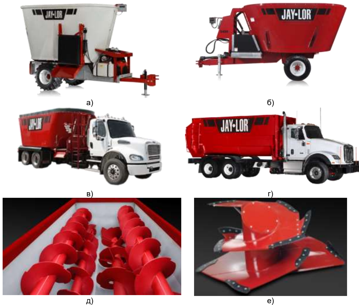
Рис. 8. TMR змішувачі компанії «Jaylor»: а) причіпний змішувач «Jaylor 5100 Trailer»; б) причіпний змішувач «Jaylor 5400 Single Auger TMR Mixer»; в) вертикальний змішувач у конфігурації на шасі вантажного автомобіля «5850HD TMR Truck Mount»; г) горизонтальний змішувач на шасі автомобіля «Jaylor H1850 Quad Auger Mixer»; д) робочий орган «Square-Cut Auger»
