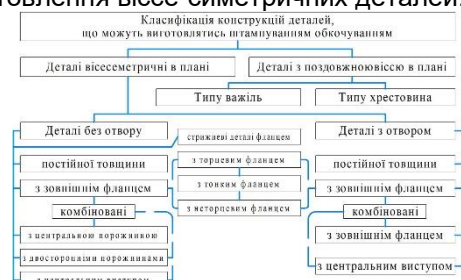
Рис. 3. Класифікація деталей за формою, що можуть виготовлятися методом ШО ефективно
