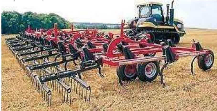
Рис.1. Трактор Caterpillar «Challenger» з причіпним широкозахватним культиватором Horsch FG 18.30
