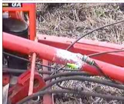
Рис. 5. Дишло культиватора: а) місця розміщення вимірювальних точок; б) месдоза стиску 40 кН (т.5); в) тяга рами дишла з тензодатчиками (т.7)
