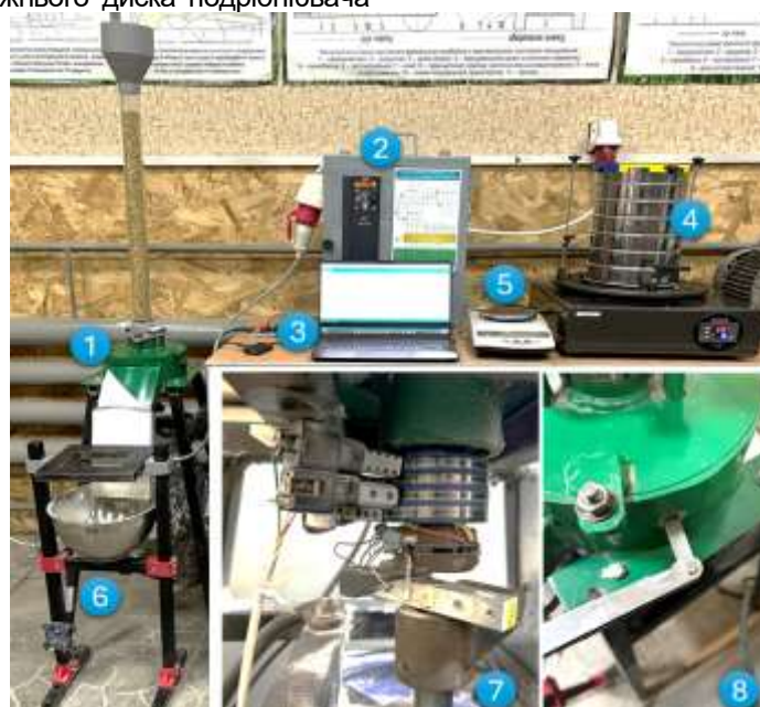
Рис. 5. Загальний вигляд дослідної установки на основі експериментального дискового подрібнювача: 1 – дисковий подрібнювач; 2 – стелд для керування електроприводами на основі частотного перетворювача Danfoss; 3 – ПЕОМ; 4 – розсійник лабораторний; 5 – ваги лабораторні; 6 – система зважування у поточному часі готового продукту; 7 – вимірювач крутного моменту; 8 – отвір для встановлення модульного зазору
