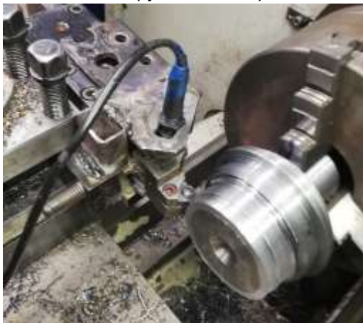
Рис. 5. Дослідження АК різцем-осцилятором з однією степеню свободи в напрямку вісі Z
