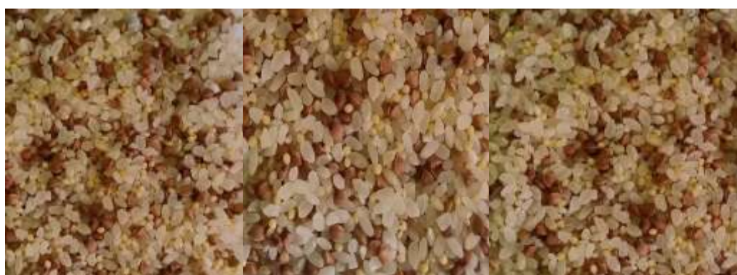
Рис. 3. Зразки багатокомпонентної суміші в різних ділянках робочої камери
