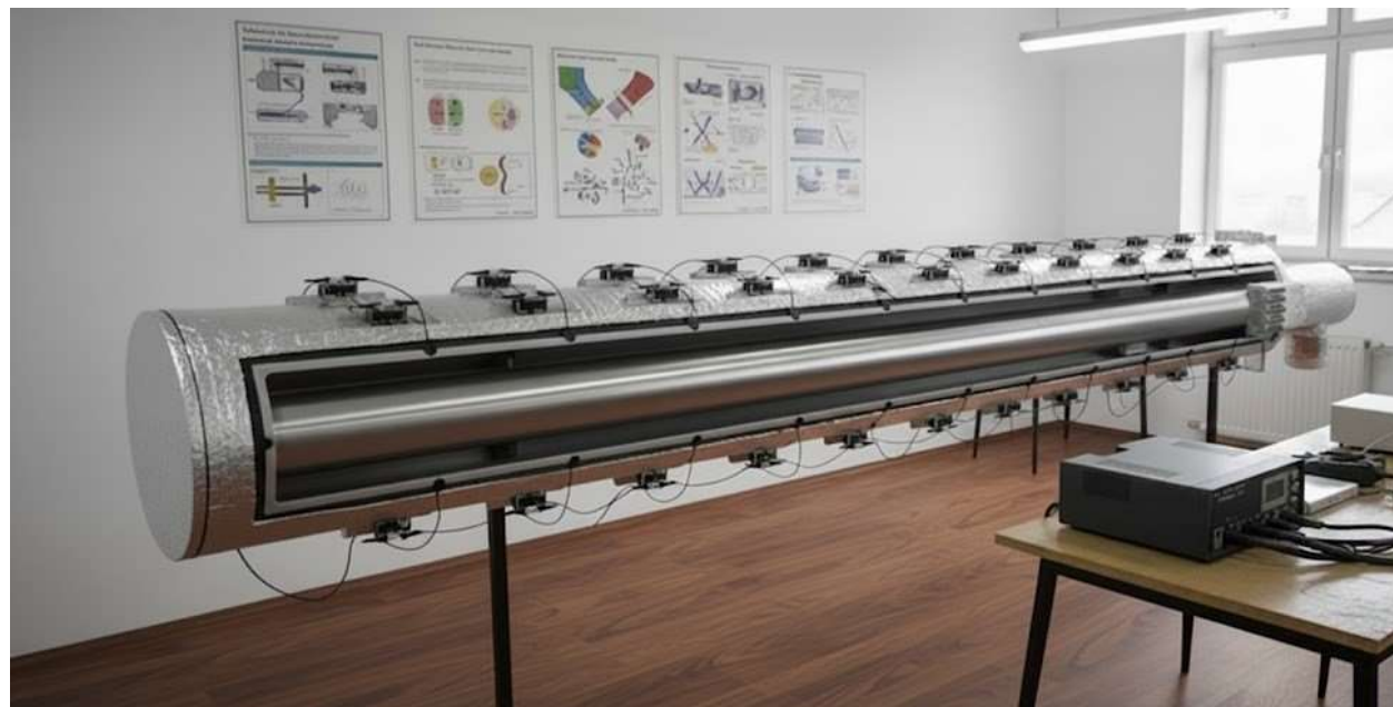
Рис. 1. Технологічна схема (а) і загальний вигляд (б) експериментального стенда адаптивного тритрубного теплоутилізатора: 1 – внутрішня труба; 2 – середня труба; 3 – зовнішня труба; 4 – трубка для відведення конденсату; 5 – витяжна шахта; 6 – припливний вентилятор; 7 – витяжний вентилятор; 8 – розподільні отвори; 9 – повітряний фільтр; 10 – каналний електричний нагрівач; 11 – заслінка; 12 – сервопривод заслінки; 13 – датчик температури; 14 – датчик швидкості повітря; 15 – сигнальні проводи; 16 – блок керування; 17 – датчик якості повітря.
