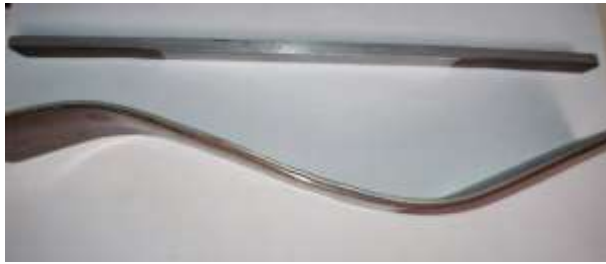
Рис. 7. Зразки після випробування на вигин
