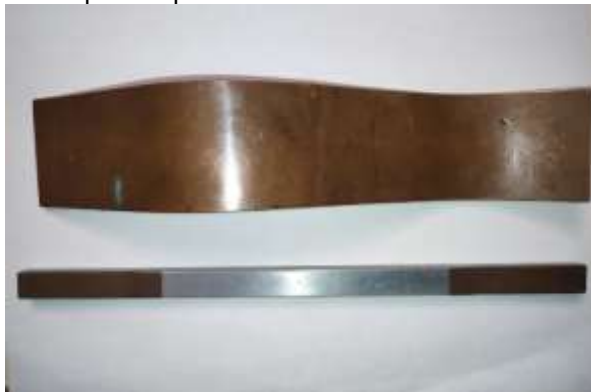
Рис. 8. Готова електрошина плакована по всій довжині (алюміній + мідь)
