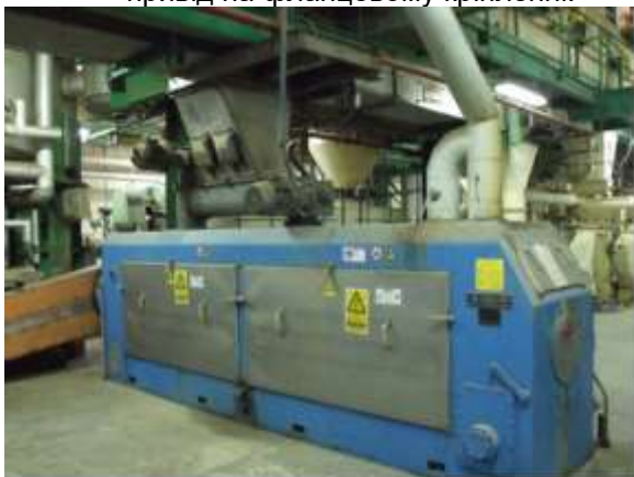
Рис. 5. Прес Krupp EP20 з модифікованим дизайном живильного пристрою (вертикальний+горизонтальний)
