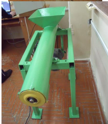
Рис. 4. Загальний вигляд шнекового транспортера
