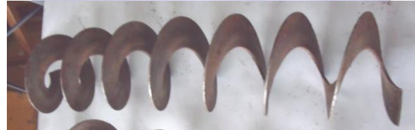
Рис. 5. Загальний вигляд шнека та заготовки спіральних витків змінного кроку
