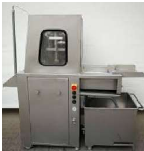
Рис. 2 Багатоголковий електромеханічний ін'єктор розсолу NK-27 виробництва «Karpowicz» (Польща) [16]
