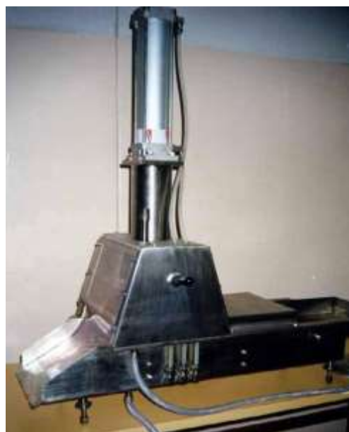
Рис. 1 Ін'єктор-автомат Я5-ФШ1Л з двома пневмоприводами
