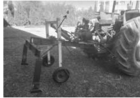
Рис. 1 Дослідний агрегат для обробітку ґрунту із контролем щільності. [2]
