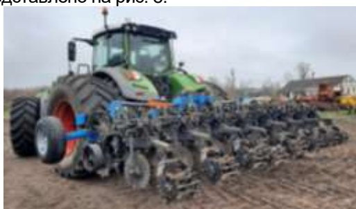
Рис. 8. Культиватор запропонованої конструкції навішаний на трактор FENDT 900 Vario.
