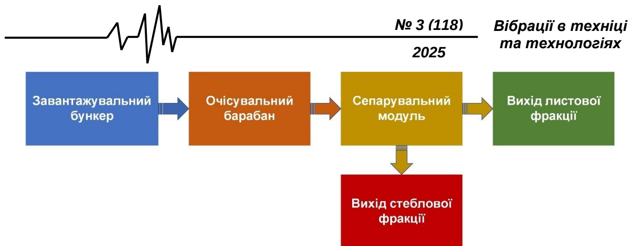
Рис. 6. Принципова схема фракційної машини з очісувальним барабаном
