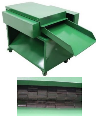
Рис. 4. Листообдирна машина типу Stem–Leaf Separator для відокремлення листової фракції від стебел сухої люцерни
