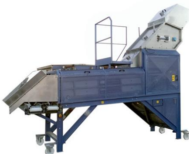
Рис. 5. Машина для відокремлення листової фракції від стебел сухої листостеблової маси Rebler LGU 200
