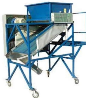
Рис. 3. Машина для розділення зібраної сухої ромашки на стебла та суцвіття OGK 1003-A
