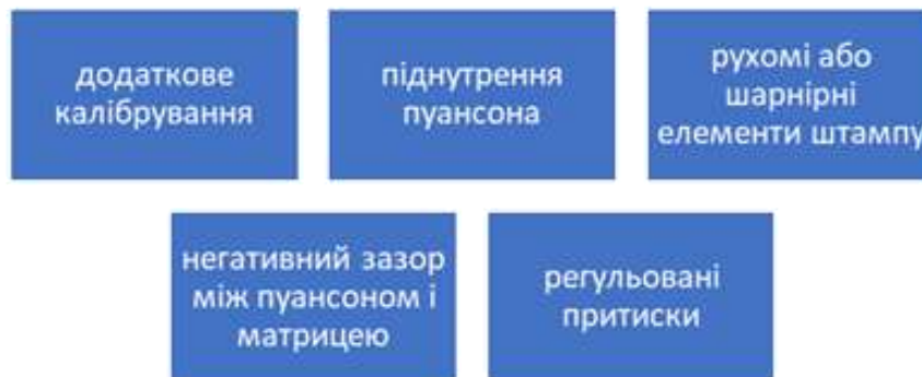
Рис. 2. Основні методи компенсації пружного повернення при згинанні листових заготовок
