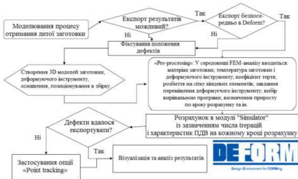
Рис. 1. Алгоритм моделювання наскрізних технологічних процесів виробництва в програмних комплексах скінчено-елементного моделювання типу DEFORM-3D.
