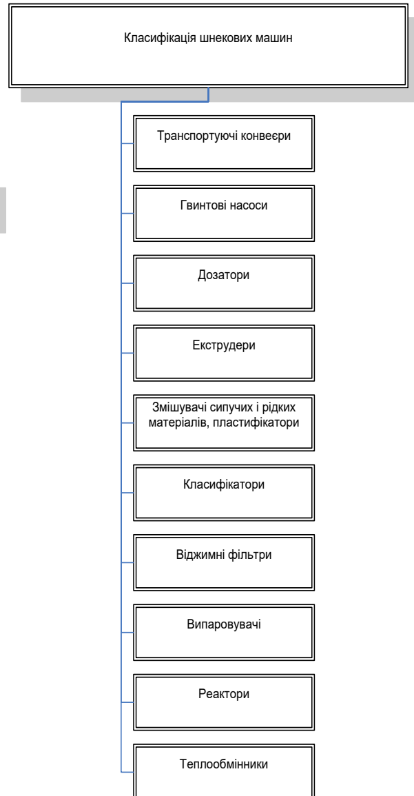
Рис. 1.3. Класифікація шнекових машин за технологічними задачами
