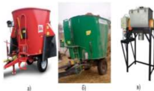
Рис. 1.15 Кормозмішувачі шнекові: а - Agilo V-MIX (компанія BvL); б - КСП-9 (ТДВ «Брацлав»); в - СПП-2500 (ТОВ «Технолог»)
