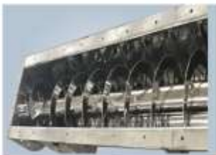
Рис. 1.17. Змішувачі з горизонтальним розміщенням стрічкового шнека: а - з одним шнеком; б - з двома різнонаправленими шнеками.
