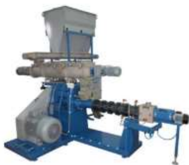
Рис. 1.14. Шнековий екструдер E-1500 (ПАТ «ЧеркасиЕлеваторМаш»)
