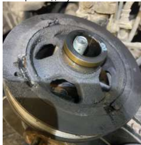
Рис. 3. Механічне пошкодження шківів колінчастого вала
