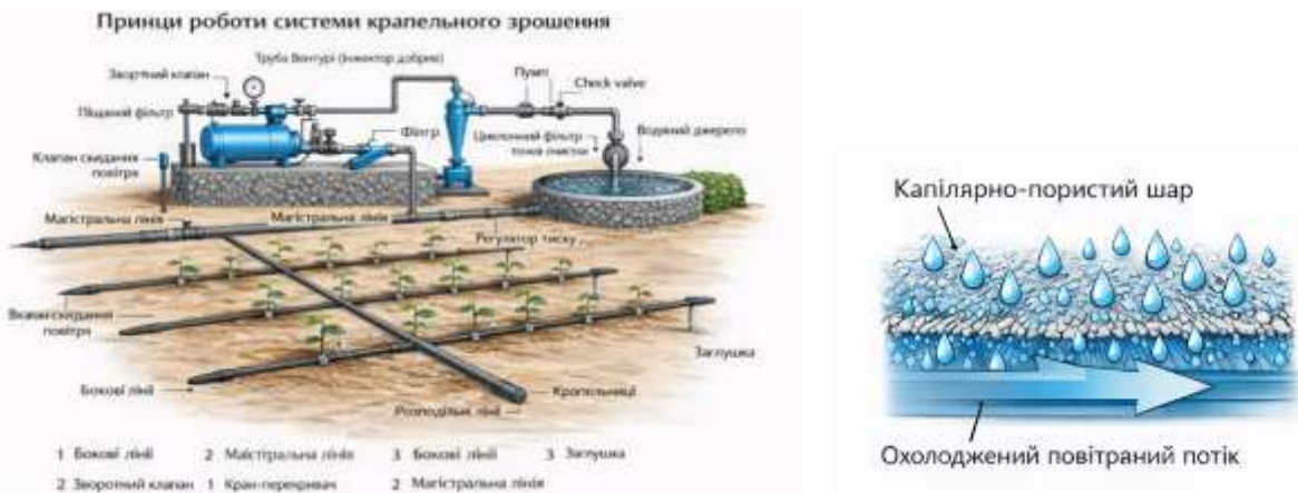
Рис. 4. Схема використання капілярно-пористого матеріалу на зволоженій поверхні теплообмінника
