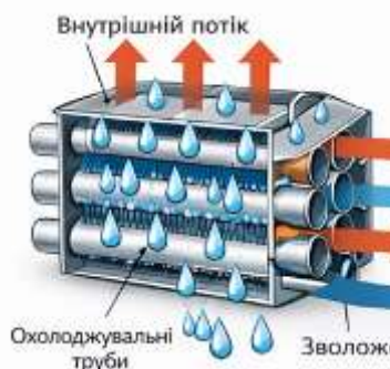
Рис. 3 Трубчастий теплообмінник побічно-випарного типу з зовнішнім зволоженням труб
