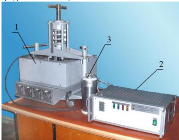
Рис. 5. Загальний вигляд лабораторної установки для визначення теплофізичних властивостей люцерни: 1 – теплоізолюванні паралелепіпеди; 2 – плоский електричний нагрівач; 3 – диференційні термометри
