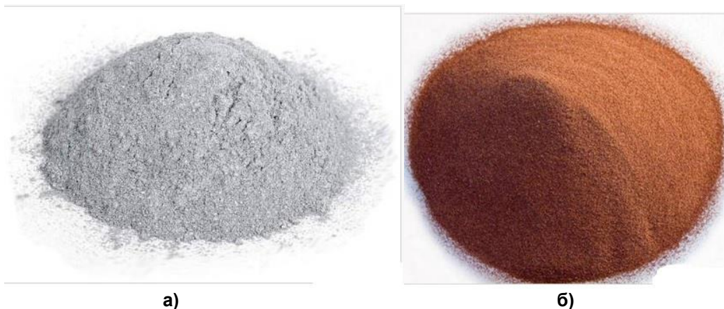
Рис. 1. Вигляд порошків, що формують суміш для напилення: а - порошок алюмінію А 20-11, б - порошок міді С01-11
